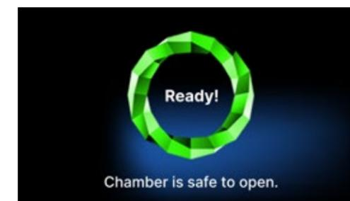
Si le processus a réussi, l'écran affiche alternativement des écrans d'information sur la fin du processus et la stérilité de la charge et sur la possibilité d'ouvrir la chambre de l'appareil. En appuyant sur le champ FINISH, on passe à l'écran de bienvenue.
