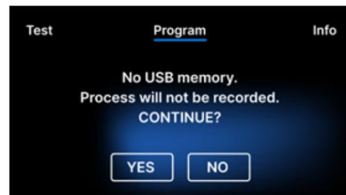
Si une clé USB n'a pas été insérée dans l'appareil, le symbole USB ne s'affiche pas dans le coin inférieur droit de l'écran et un message indiquant l'absence de clé USB s'affiche. Les données du programme de test ne seront pas enregistrées. On peut continuer sans écrire de données sur la clé USB en appuyant sur la case OUI ou abandonner en sélectionnant la case NON pour placer la clé USB dans le port et recommencer le programme depuis le début.
