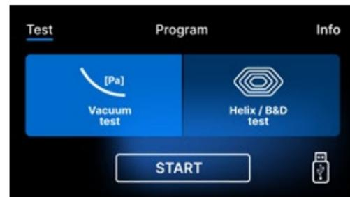
Lorsque la chambre de travail de l'appareil est fermée, le mot DOOR OPEN devient START et en appuyant sur ce champ, le programme d'essai sélectionné est lancé.
