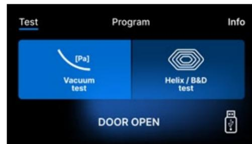
En appuyant sur le champ Test, vous accédez au menu des programmes de test. A ce niveau, nous pouvons choisir entre les programmes de test Vacuum test et Helix / B&D test. Nous sélectionnons le programme approprié en appuyant sur le champ requis sur l'écran.
