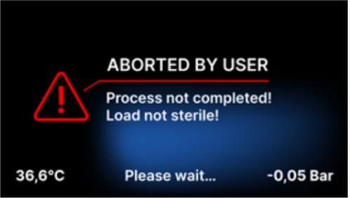
Lorsque la pression dans la chambre de travail est égalisée, les messages suivants apparaissent alternativement sur l'écran. Vous pouvez maintenant ouvrir l'appareil librement. Après avoir ouvert la chambre, l'écran apparaît.
